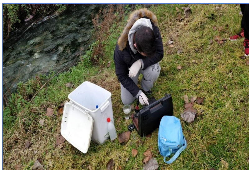
Εικόνα 3.2: Δειγματοληψία (αριστερά) και μέτρηση του διαλυμένου οξυγόνου στο πεδίο (δεξιά).
