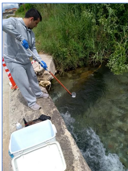
Εικόνα 3.2: Δειγματοληψία (αριστερά) και μέτρηση του διαλυμένου οξυγόνου στο πεδίο (δεξιά).
